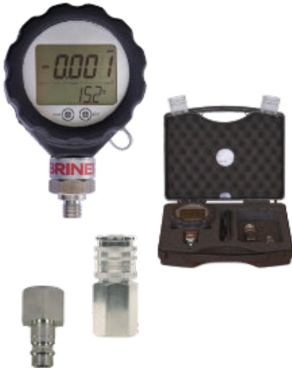
Das Manometer zeichnet den Druck- und Temperaturverlauf auf und es kann über einen USB-Anschluss am PC ausgelesen, und ein Druckprotokoll erstellt werden.
